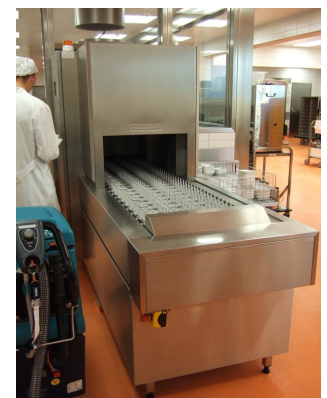
Die Bandspülmaschine verbraucht sehr viel Energie (bis zu 27 % am Gesamtenergieverbrauch).
